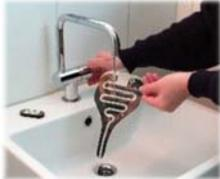
Lavare il rilevatore d'urina e il trasmettitore con l'acqua corrente tiepida
