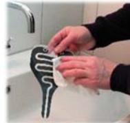
Asciugare delicatamente il rilevatore e il trasmettitore.
