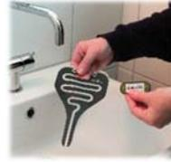
**Separare il trasmettitore del rilevatore. Ciò arresta l'allarme!**
