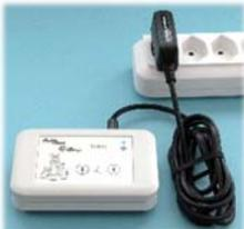
Introdurre lo spinotto rotondo del trasformatore nel retro del ricevitore
