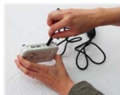
11. Introdurre lo spinotto rotondo del trasformatore di rete nella presa sul retro del ricevitore
