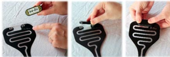
4. Fissare il trasmettitore sul rilevatore d'urina. L'orientamento della polarità è indifferente
