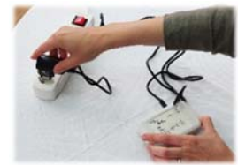
12. Collegare il trasformatore ad una presa da 230V → la spia blu si accende e si sente segnale acustico
