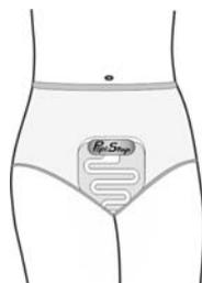
Die Urin-Folie (leitende Plastikfolie) wird im Slip getragen. So verrutscht diese nicht. Bei den ersten Tropfen Urin wird mittels des Senders ein Signal zum Empfänger übertragen: Der Alarm wird ausgelöst (Ton + Blinklicht).
