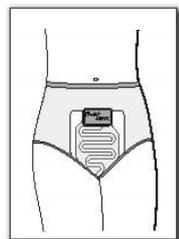
Le détecteur d'urine (feuille plastique conductrice) se porte dans un slip. Ainsi le détecteur reste bien en place. Dès les premières gouttes d'urine, l'émetteur envoie un signal au récepteur: l'alarme est activée (sonnerie + lumière clignotante).
